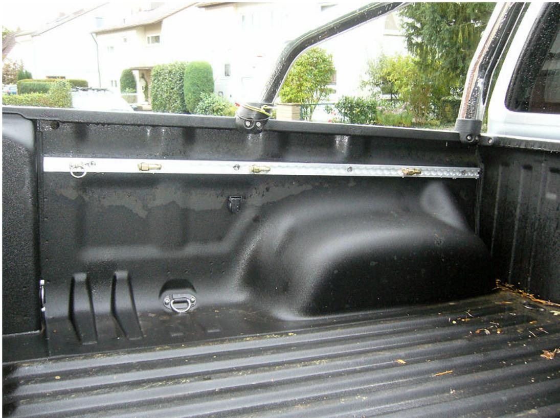
Nun wieder Tankeinfüllstutzen und Radhausverkleidungen einbauen. Wir haben das Fahrzeug nach den Montagearbeiten einen Tag stehen lassen, damit das Sikaflex 252 in Ruhe abbinden konnte.
