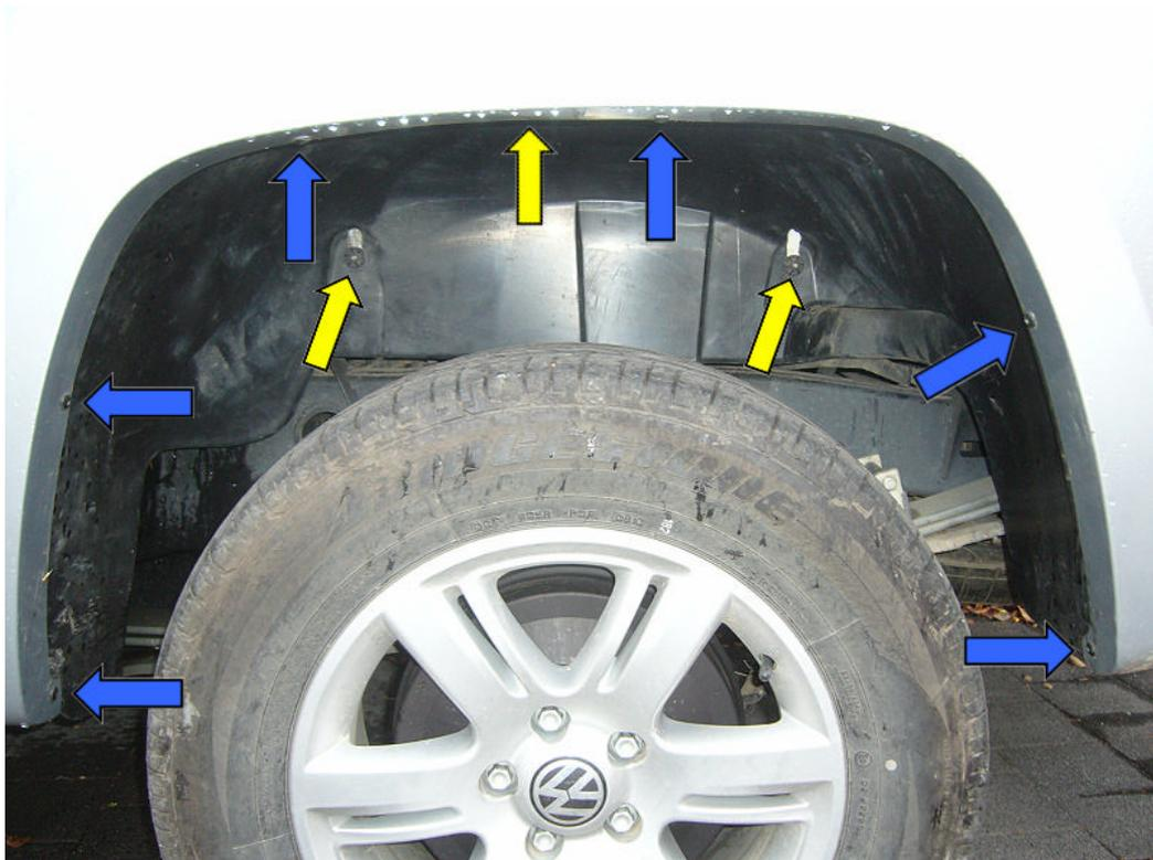
Dann die Radhausverkleidung herausziehen. Das hört sich einfacher an, als es ist. Wir haben die Verkleidung zunächst an der Kotflügelverbreiterung über den Rand gezogen, dann die ganze Radhausverkleidung nach unten gezogen. Es wird ziemlich viel Kraft benötigt. Wenn die Radhausverkleidung erst einmal auf dem Rad liegt, dann hat man gewonnen ☺.
