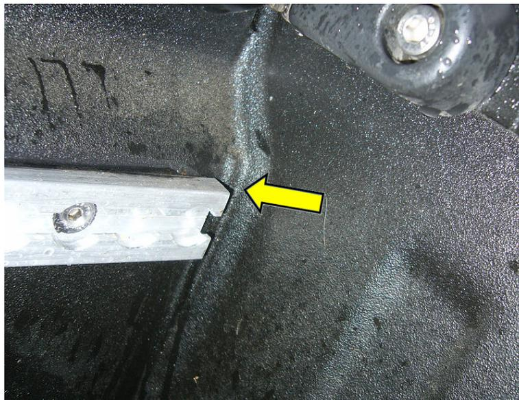
Am 3. Loch (ca. 6 cm von vorn), 20. Loch (ca. 49,5 cm von vorn), 34. Loch (ca. 85 cm von vorn) und 49. Loch (ca. 123,5 cm von vorn) haben wir zunächst mit 5 mm vorgebohrt. Die Bohrlöcher werden mittig in die Öffnungslöcher der Schienen gesetzt.
